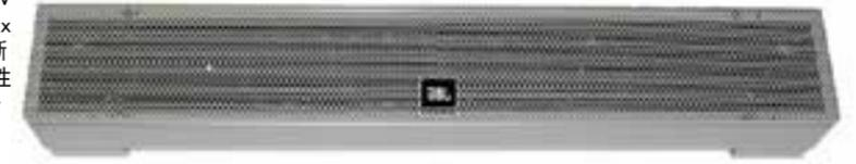
无源滤波网络对每个单元进行时间校准, 对整个线阵系统进行均衡以创建一个恒定波长的线声源。每个阵列由6个精细校准的4"全频扬声器组成, 每个扬声器都安装在一个坚硬的钢质外壳内。特别校准的单元有着高效而平坦宽广的频率响应, 以提供自然和无染色的语音与背景音乐重放。
